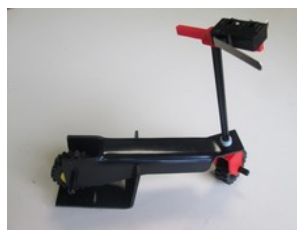
Illustration N°2 : Guidon et fourche imprimés
