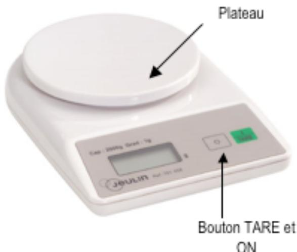
**Remarque :** Une balance est caractérisée par sa portée qui est la masse maximale qu'elle peut mesurer. **Il ne faut pas dépasser cette masse maximale sinon la balance risque d'être endommagée.**
