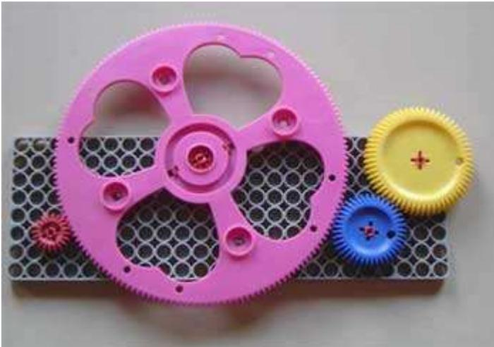
> Le nombre de roues dentées entre la roue de départ et la roue d'arrivée, ainsi que leur taille n'a toujours aucune importance.
