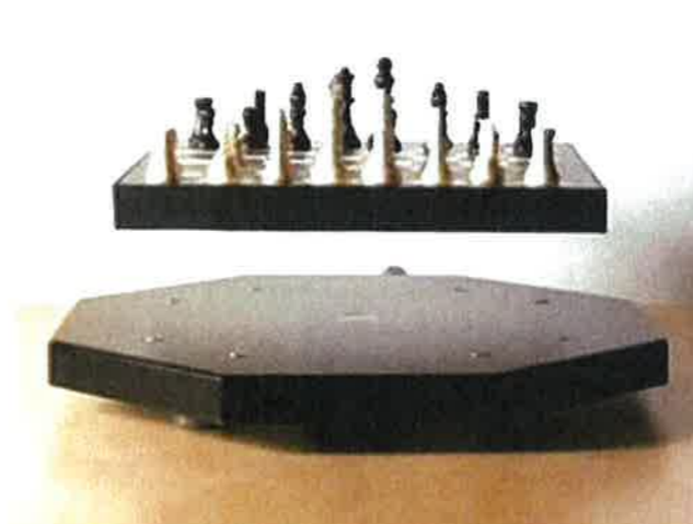
Echiquier de Crealev. Module de lévitation magnétique.
