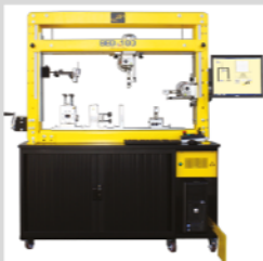
Figure 4 : Banc didactique de RDM 3R BED 100
