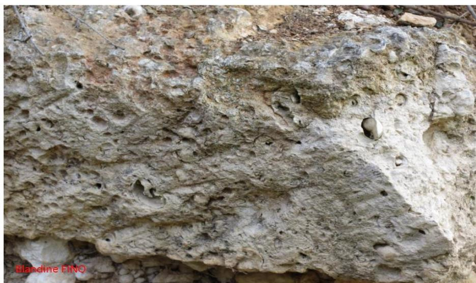
Détail d'un morceau de calcaire crayeux de Bourges.
