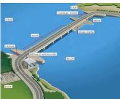
**La centrale marémotrice** : structure qui utilise l'énergie marémotrice qui est issue des mouvements de l'eau créés par les marées et causés par l'effet conjugué des forces de gravitation de la Lune et du Soleil.
