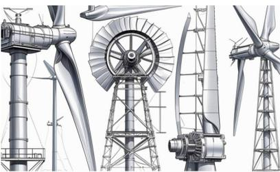
**Une éolienne** : Système à ailes ou à pales tournantes convertissant l'énergie cinétique du vent en énergie mécanique disponible sur un arbre pour entraîner une machine (pompe) ou un alternateur électrique.
